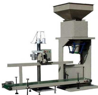
Рисунок. 2.5 - Зображення пакувальної машини для хімічного порошку [30]
