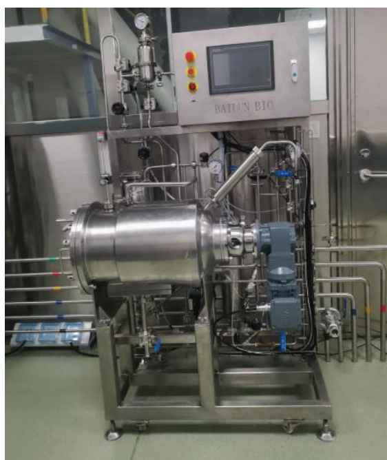
Рис.5.1 Біореактор для твердофазового культивування із системою перемішування [39]
