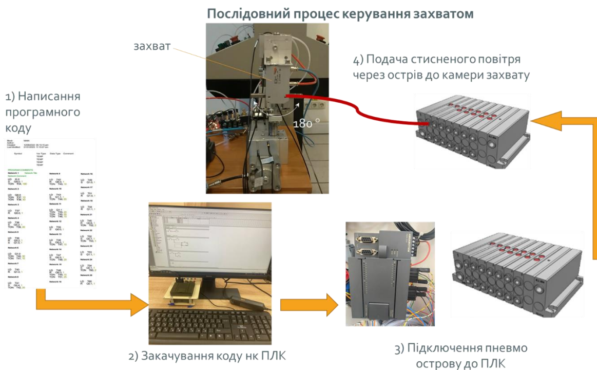
Рис.3.3. Алгоритм складання експериментальної установки
