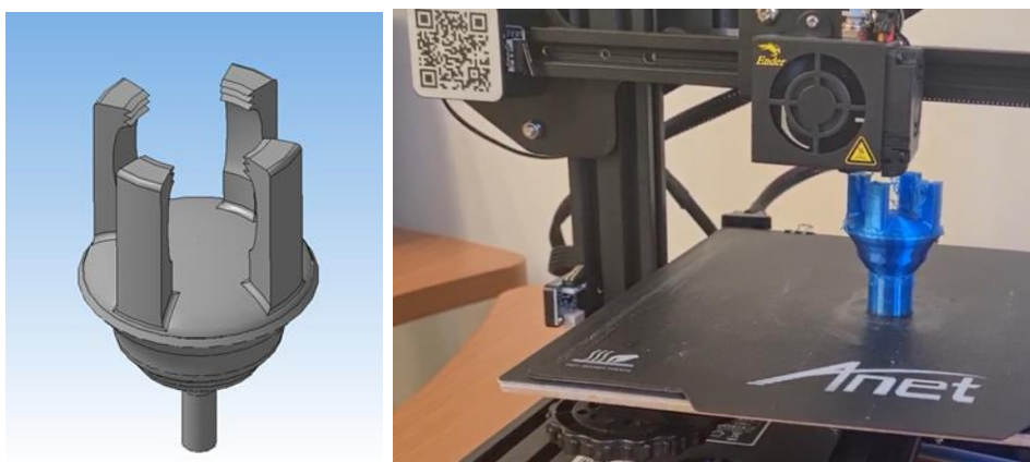
Рис.2.4. Загальний вид розробленого вакуум механічного захвата
