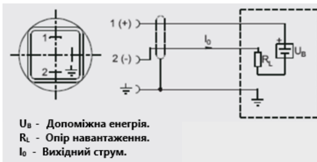
Рис. 2.2 Підключення SITRANS TF2 до двопровідної схеми живлення
