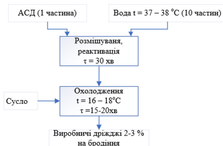
Рисунок 3.2 – Схема приготування виробничих дріжджів (АСД)
