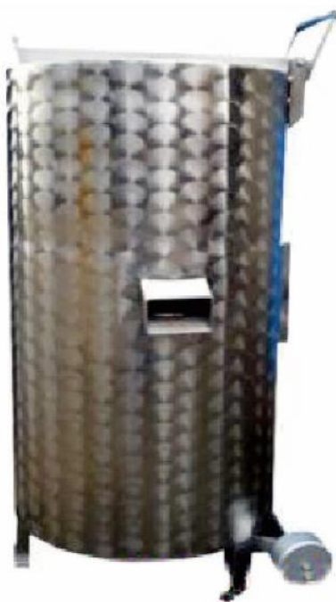
Рис. 4.3. Машинка для мийки, опирки і очищення слизових субпродуктів
