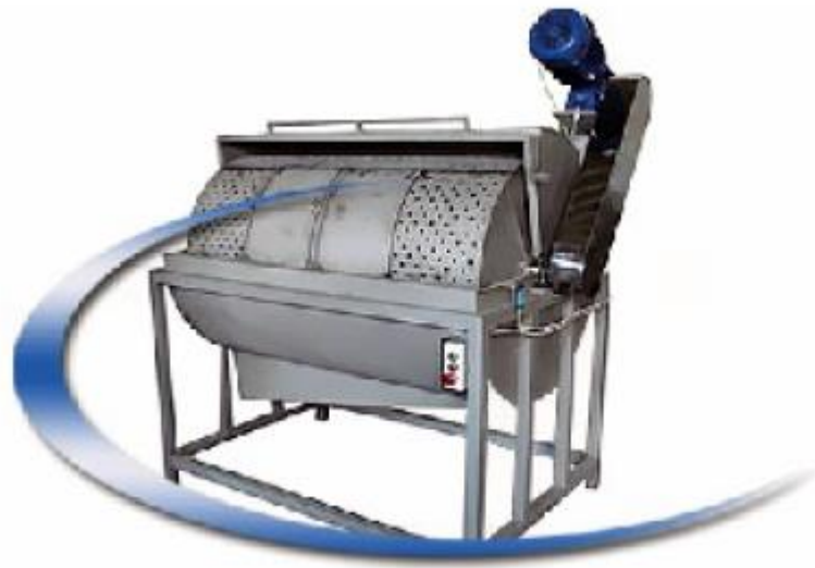
Рис. 4.2. Машина для первинної обробки слизних і м'якотних субпродуктів ММС-1
