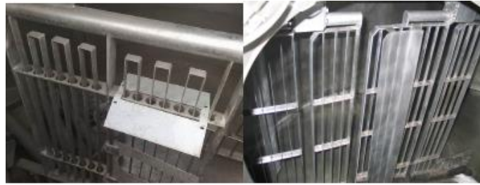
Рис. 1.2. Відкрита сироробна ванна з перемішувальним пристроєм: а – загальний вигляд: 1 – сирна ванна з теплозахисною сорочкою, балкою і приводом для робочих органів; 2 – робочий орган для перемішування; 3 – різальний інструмент; 4 – фільтр для сироватки; 5 – насос для викачування сироватки на візку з неглибоким контейнером; 6 – плити попереднього пресування для виготовлення сиру з круглими комірками; 7 – балка для кріплення інструментів; 8 – гідравлічні циліндри для плит попереднього пресування; 9 – сирний ніж; б – різально-перемішувальний робочий орган
