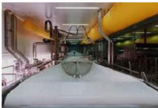
Рис. 1.11. Апарат безпервної дії фірми Алрта для виготовлення сирного зерна: 1 - впускна труба; 2 - зона сквашування; 3 - жолобоподібний стрічковий транспортер; 4 - робоча ємність; 5 - електростатичний відділювач згустку; 6 – пристрій для розрізання пласту (горизонтальний); 7 - пристрій для поперечного розрізання пласту; 8 - пристрій для очищення розділювальних перегородок
