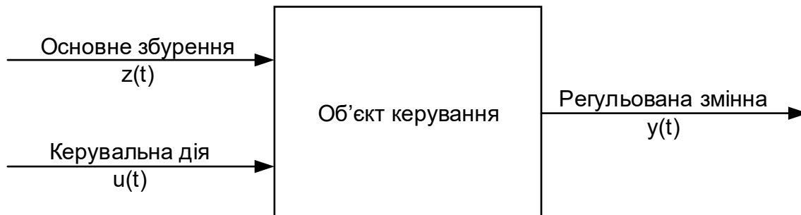
Рис. 7.2. Параметрична схема по каналу регулювання температури нагріву емульсії в змішувачі.
