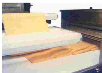
Рис. 7. Механизмы слоения тестовой ленты с помощью качающегося лотка и специальной подвижной каретки
