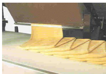
Рис. 7. Механизмы слоения тестовой ленты с помощью качающегося лотка и специальной подвижной каретки
