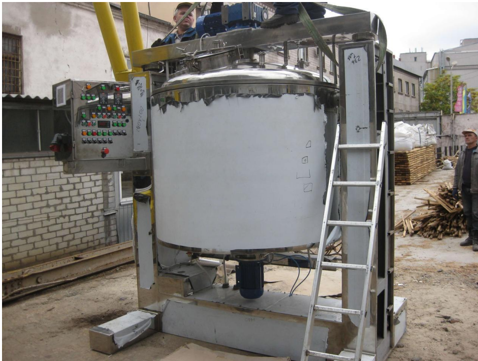
Рис.2.3 Ємнісний реактор з якірною мішалкою
