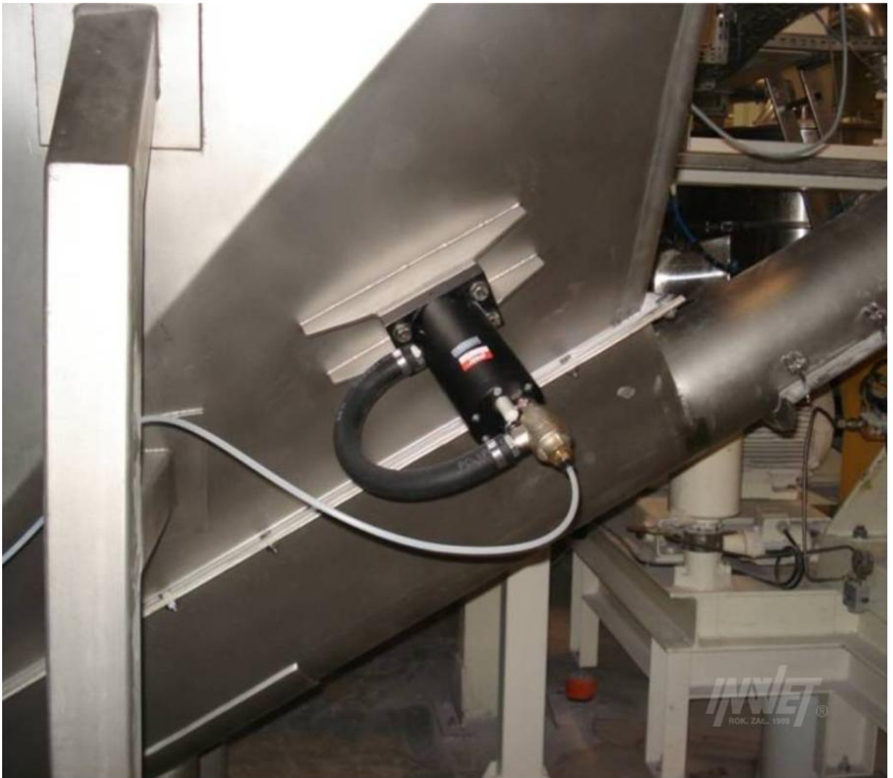
Рис.1.2.3. Схема кріплення пневмострушувача до бункера живильника.
