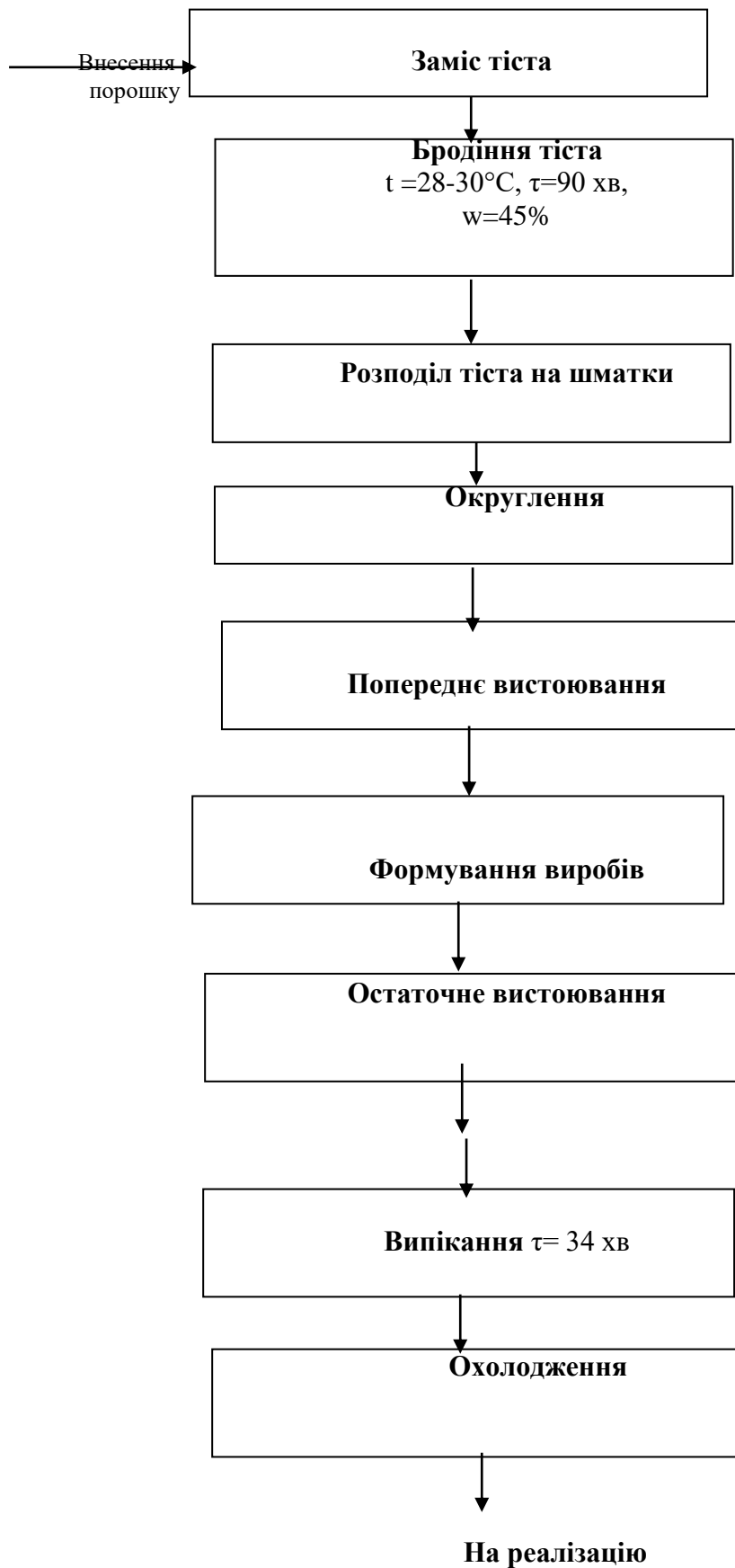
Рис.2.1 Принципова технологічна схема виробництва пшеничного хліба з додаванням порошку цукрового буряка та червоної горобини
