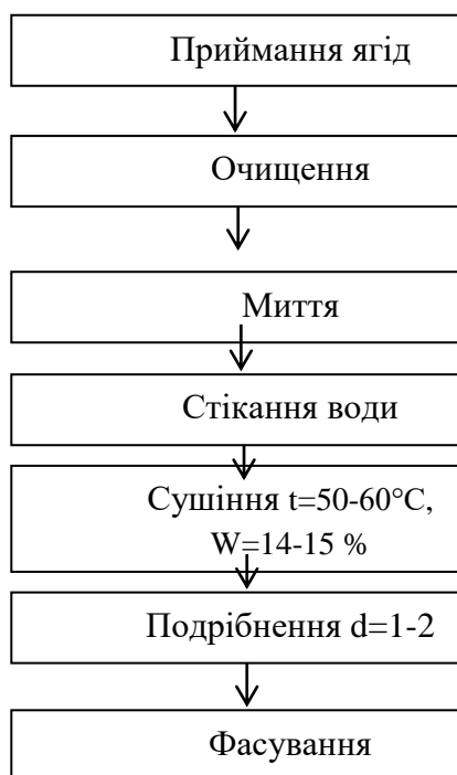
Рис. 2.3 Принципово-технологічна схема отримання порошку з червоної горобини
