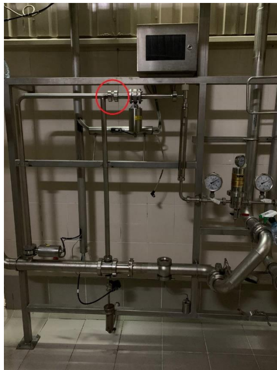
Рис. 4.1 – Панель аерації сусла
