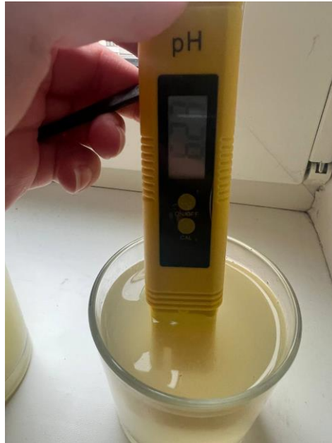
Рис. 3 – Вимірювання активної кислотності екстрактів кардамону за допомогою портативного рН-метру
