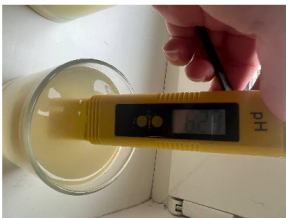
Рис. 3 – Вимірювання активної кислотності екстракта кардамону за допомогою портативного рН-метра
