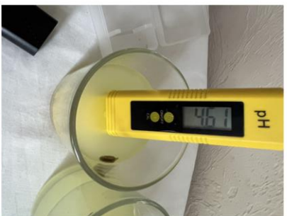
Рис. 4 - Вимірювання активної кислотності ферментованого сироваткового напою
