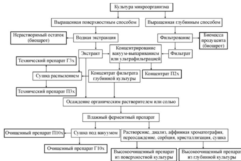
Рис.5.2 Схема виділення та очищення ферментних препаратів [69].
