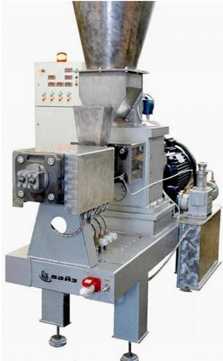
Рис. 1.2.2.1 Загальний вид двошнекового екструдера марки «Вайз 200»
