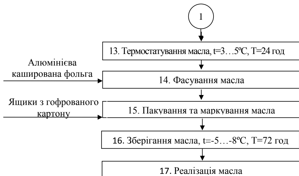
Рис. 3.1. Діаграма послідовності діючих процесів виробництва масла вершкового селянського, 72,5 %
