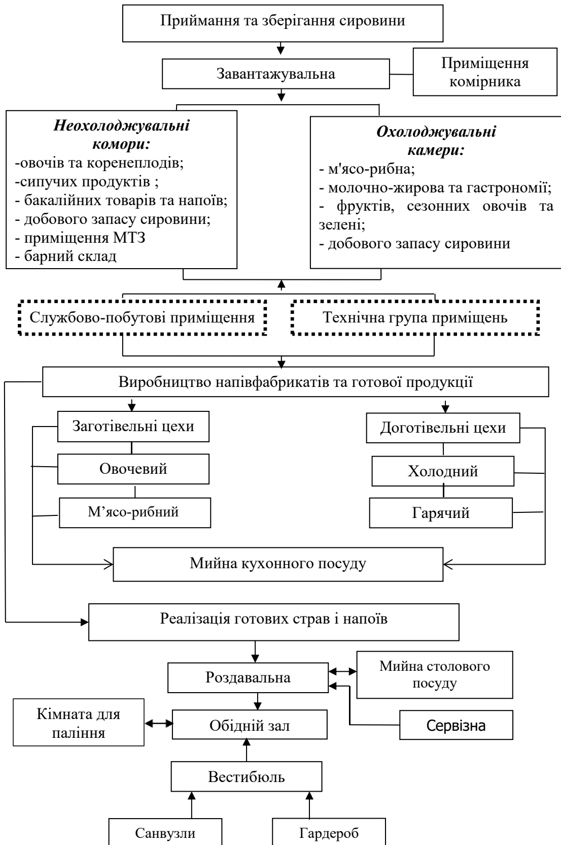
Рис. 3.2 - Структурно-технологічна схеми виробництва проєктованого закладу ресторанного господарства
