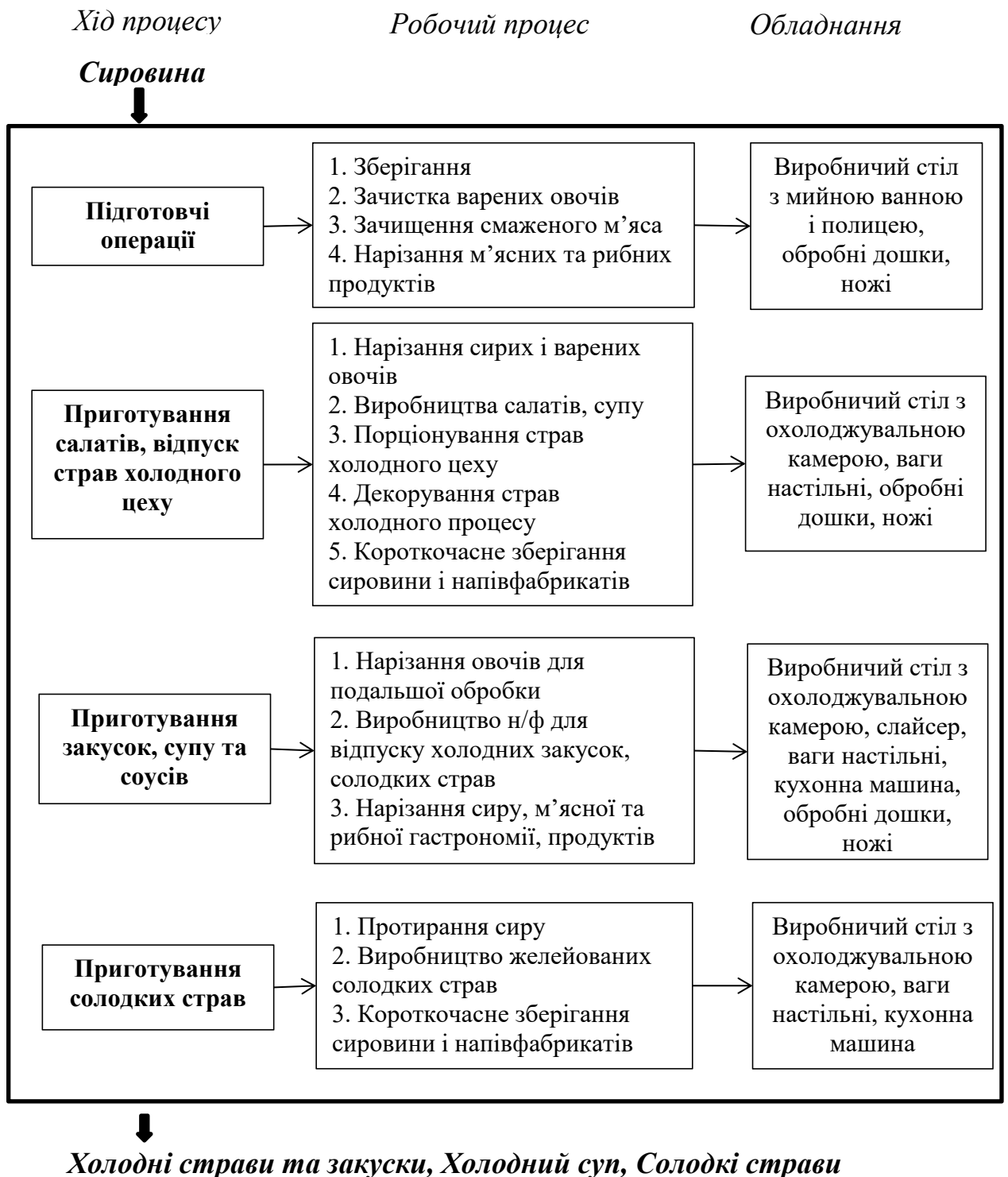
Рис.3.4 - Структурно-технологічна схема виробничого процесу холодного цеху
