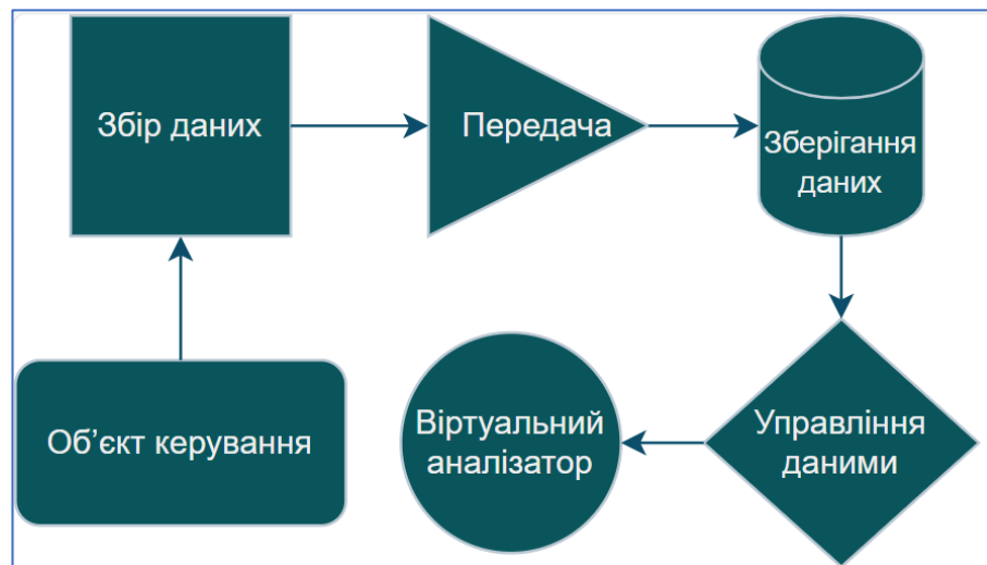
Рис. 4.41. Структурна схема архітектури для впровадження віртуального аналізатору
