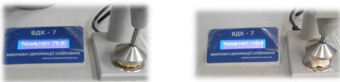
Рис. 2.9 – Дослідження розтяжності клейковини: а – пшеничного борошна; б - пшеничного борошна з додаванням цитрусового пектину; в - пшеничного борошна з додаванням цитрусового пектину та порошку гарбуза
