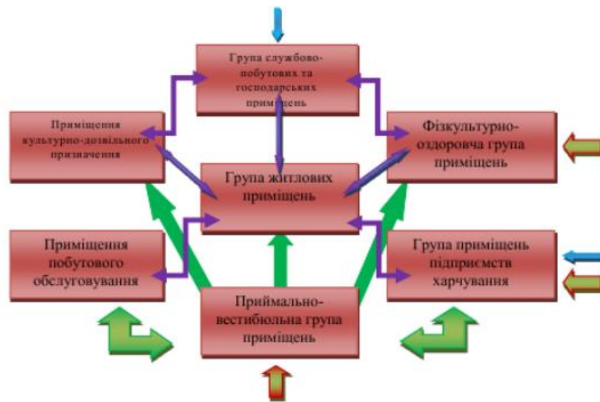
Рис.3.1 – Функціональна схема курортного готелю з аналітичною системою управління послугами в м. Одеса
