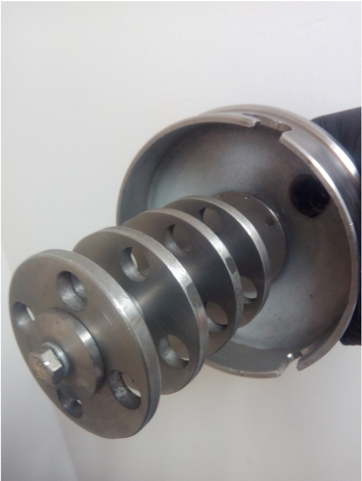
Рисунок 2.8. Робочий орган лабораторного бісерного млина
