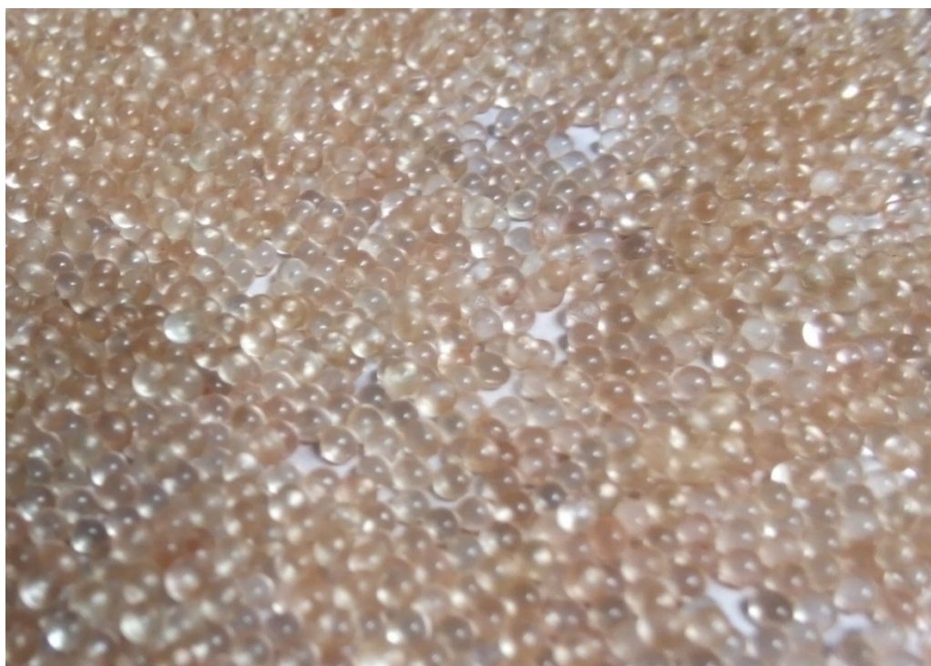
Рисунок 2.7. Робочі тіла – бісер. Скло, діаметр 2 мм.
