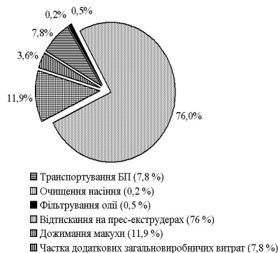
Рис. 1. Діаграма витрат енергомосткості технологічного процесу
