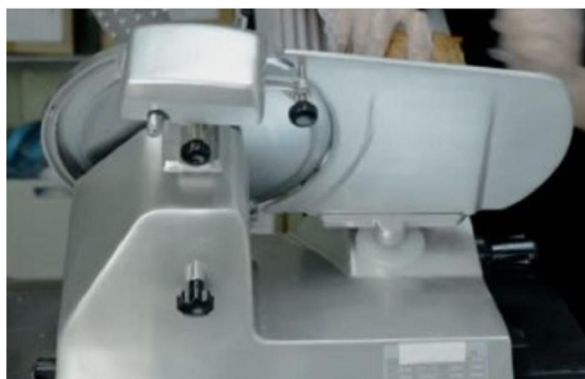
Рис. Машина для нарізання гастрономічних товарів Старт Ауто фірми METOS (Фінляндія)
