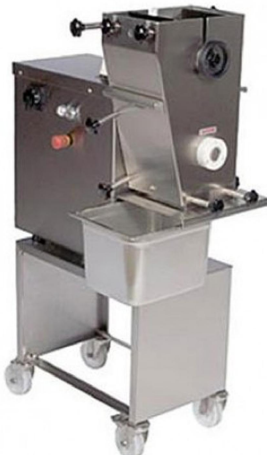
Рис. Машина для нарізання м'яса типу F-S19 (КТ, Фінляндія)
