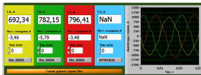
Рисунок 11 – Панель ресстратора з миттєвими значеннями струмів в трьох фазах під час вимірювання параметрів сонячної електроенергії
