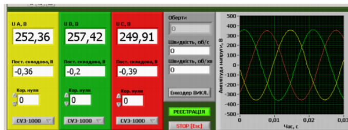
Рисунок 10 – Панель ресстратора з миттєвими значеннями напруг в трьох фазах під час вимірювання параметрів сонячної електроенергії
