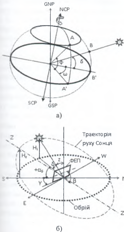
Рис. 1. Схема визначення положення точки А на поверхні Землі відносно сонячних променів (а) і кута інсоляції довільно орієнтованої площини ФЕП (б).
