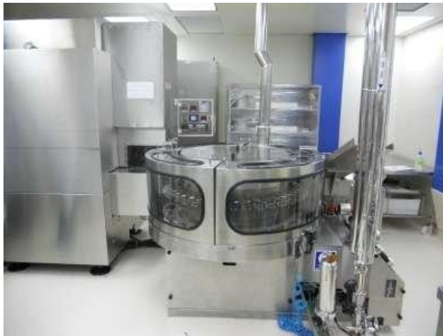
Рис. 8.2. Лінія миття та стерилізації флаконів Bosch з мийною машиною RRU 3040 і стерилізаційним тунелем HQL 2240
