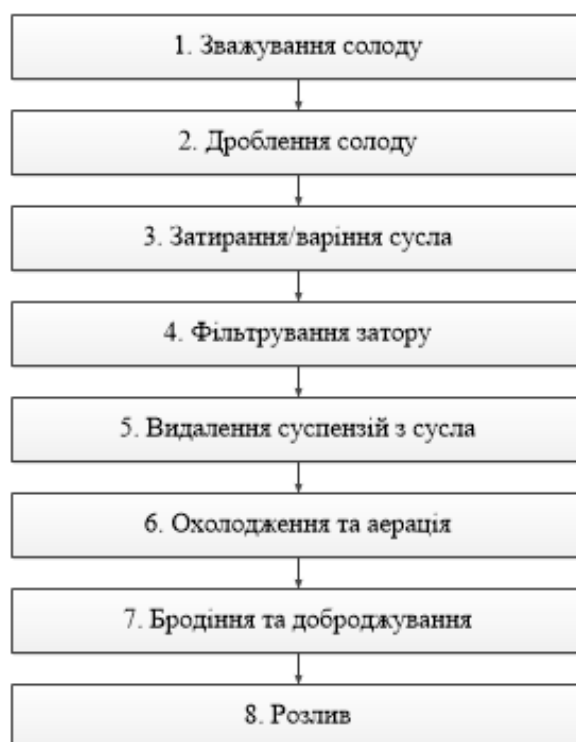
Рис. 2.1. Схема технологічного процесу виготовлення пива ПрАТ «Оболонь»
