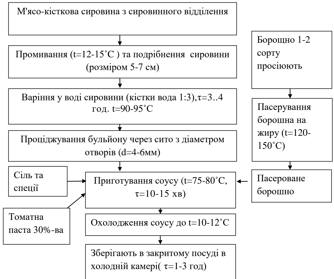
Рис.3.3. Технологічна схема приготування соусу
