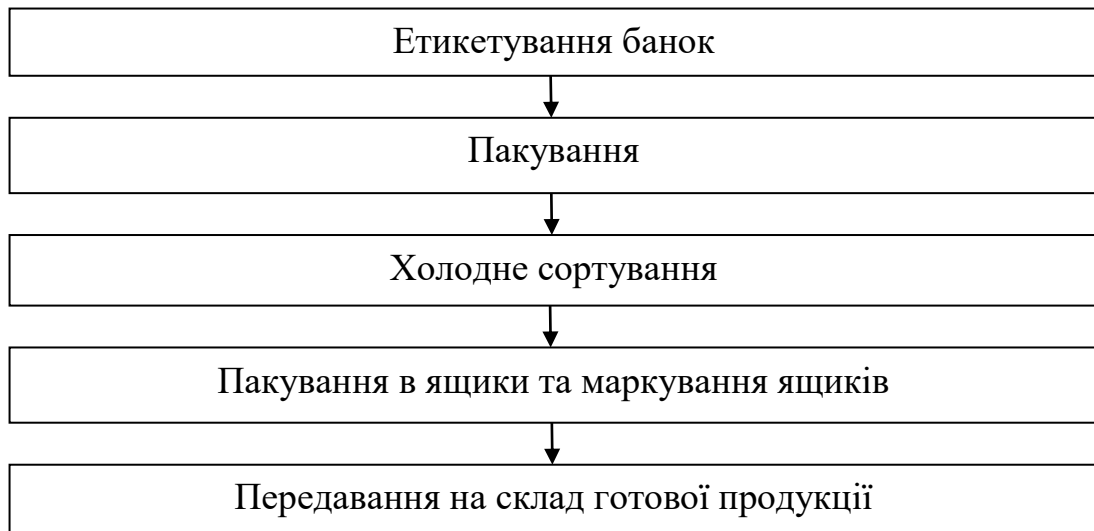
Рис. 3.1. Технологічна схема виробництва консервів «Свинина з нутом»
