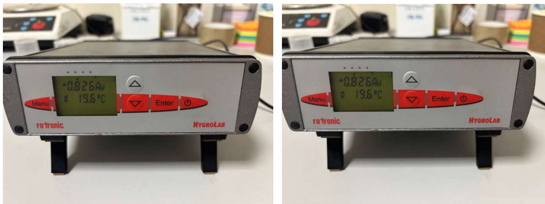
Рис. 2.5. Вимірювання активності води на HygroLab Rotronic .
