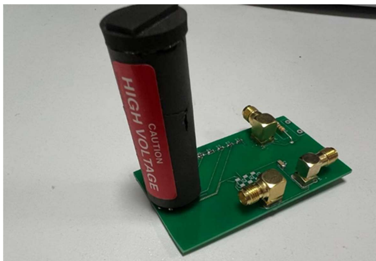
Рис. 1. Детектор з ФЕП та подільником напруги
