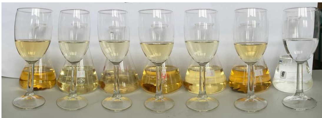
Рис. 9.4. – Колір зразків дистилату після 4-місячної витримки на дубовій трісці різного ступеня обпалення: 1 – скельний, М ; 2 – скельний + звичайний, М ; 3 – скельний + звичайний, М+ ; 4 – звичайний, М ; 5 – звичайний, М+ ; 6 – скельний + звичайний, М++ .
