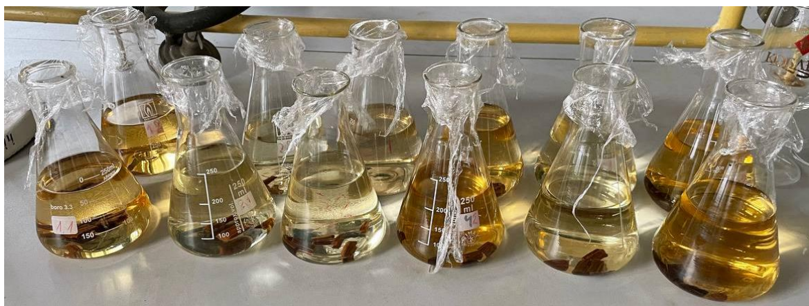
Рис.9.3. – Колір зразків дистиляту через місяць витримки на дубовій трісці різного ступеня обпалення: 1 – скельний, М ; 2 – скельний + звичайний, М ; 3 – скельний + звичайний, М+ ; 4 – звичайний, М ; 5 – звичайний, М+ ; 6 – скельний + звичайний, М++ .
