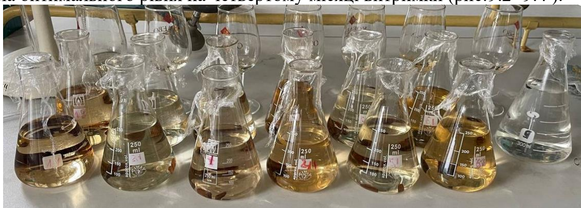
Рис. 9.2. – Колір зразків дистиляту після тижня витримки на дубовій трісці різного ступеня обпалення: 1 – скельний, М ; 2 – скельний + звичайний, М ; 3 – скельний + звичайний, М+ ; 4 – звичайний, М ; 5 – звичайний, М+ ; 6 – скельний + звичайний, М++ .
