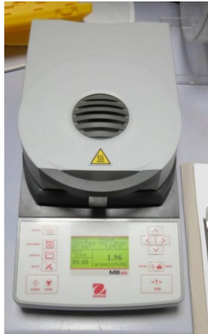
Рис.6.1. Прилад MB45 OHAUS для визначення вмісту вологи.
