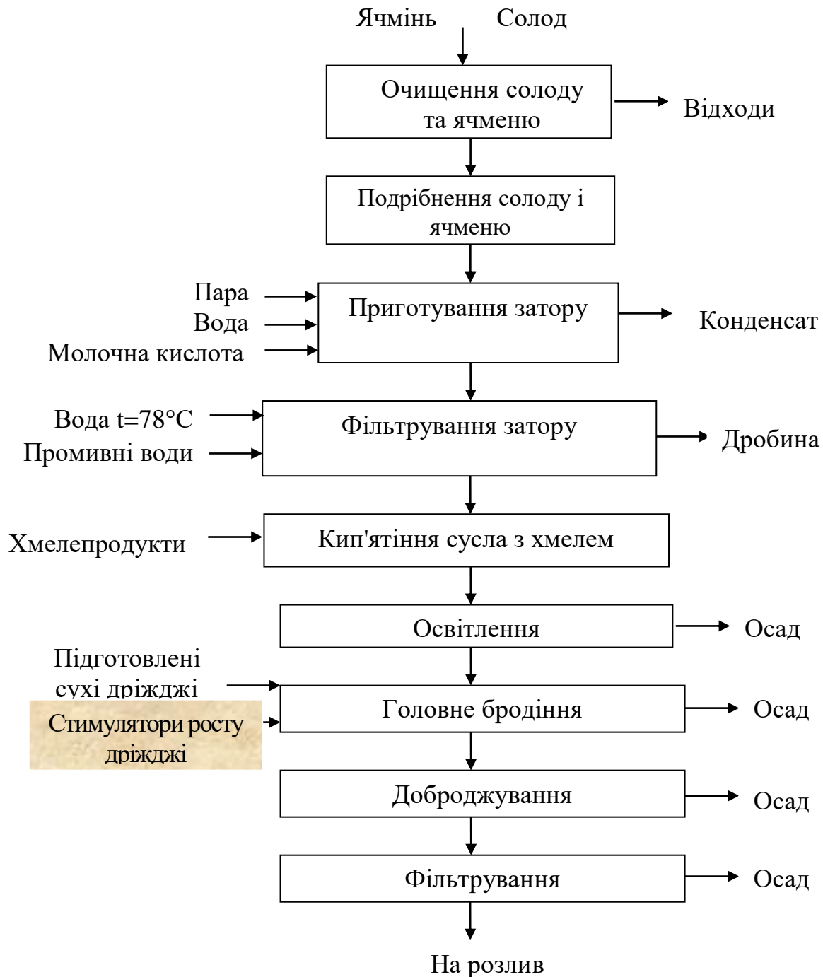
Рис 3.4 – Принципова технологічна схема виробництва пива за удосконаленою технологією
