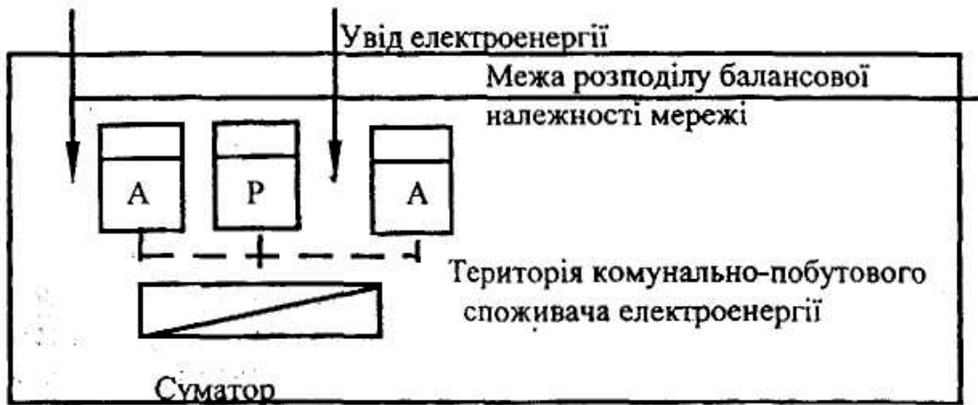
Рисунок 9.2 – Узагальнена структурна схема організації обліку електроспоживання на комунально-побутовому об'єкті
