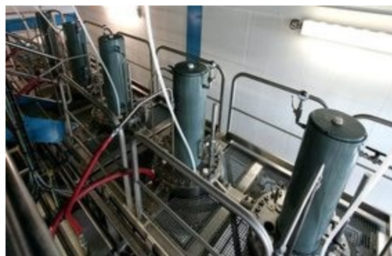
Рис.5.6. Хроматографічна система Prochrom Varicol® Multicolumn [113]
