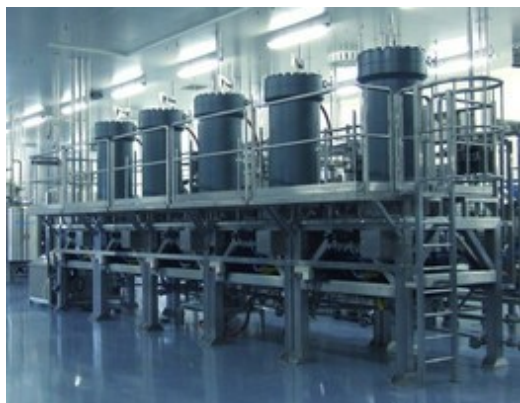
Рис.5.6. Хроматографічна система Prochrom Varicol® Multicolumn [113]
