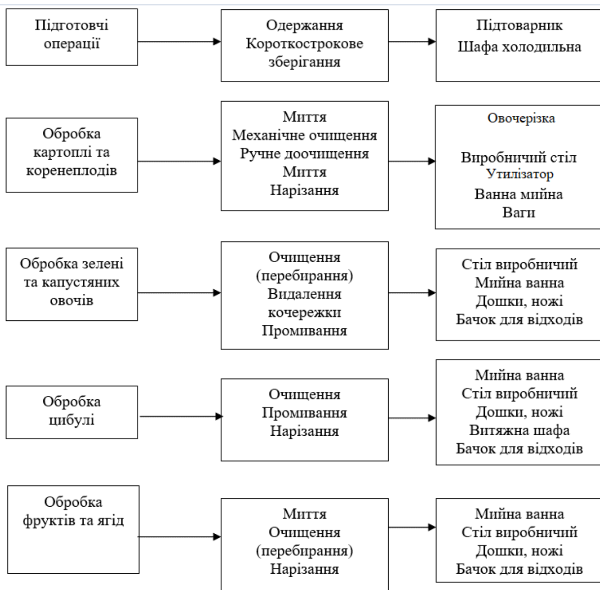
Рис.2.2 - Структурно-технологічна схема виробничого процесу овочевого цеху
