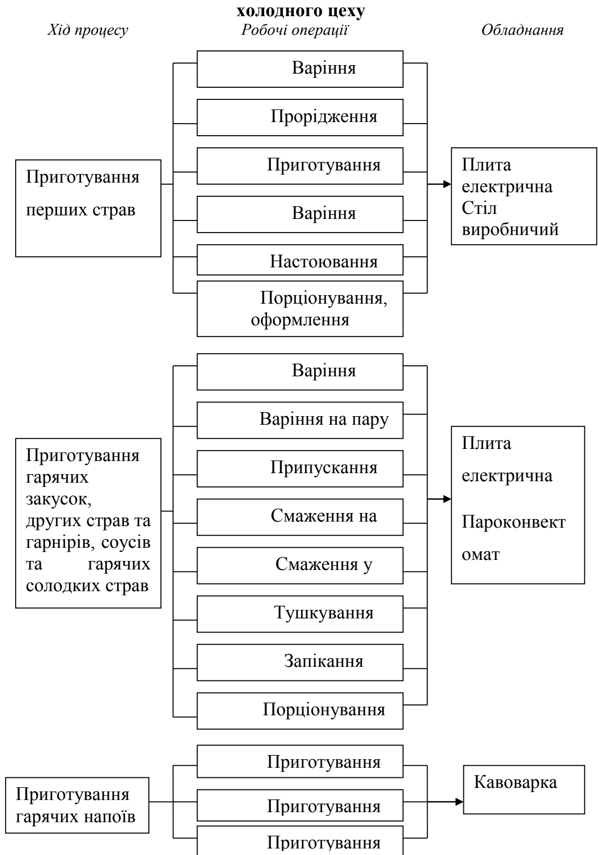
Рис. 3.4 – Структурно-технологічна схема виробничого процесу гарячого цеху
