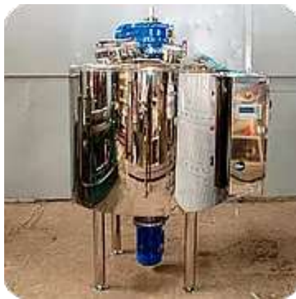
Рисунок 4.2 - Реактор з пропелерною мішалкою та сорочкою
