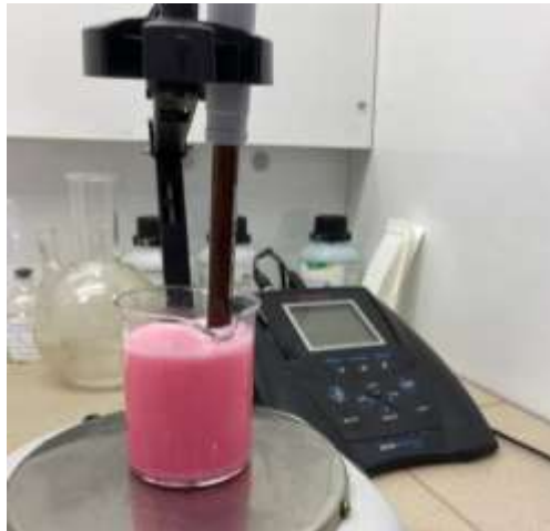
Рисунок 3.3 Вимірювання рН у дослідному зразку
