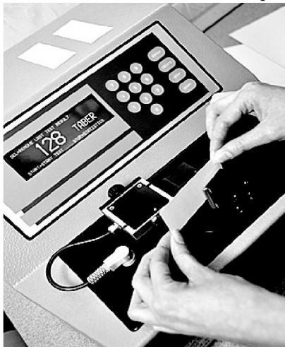
Рисунок 5 – Прилад для визначення опору згину К-416
