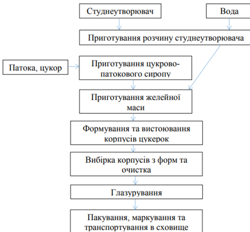
Рисунок 1.1 – Структурна схема процесу виробництва желейних цукерок
