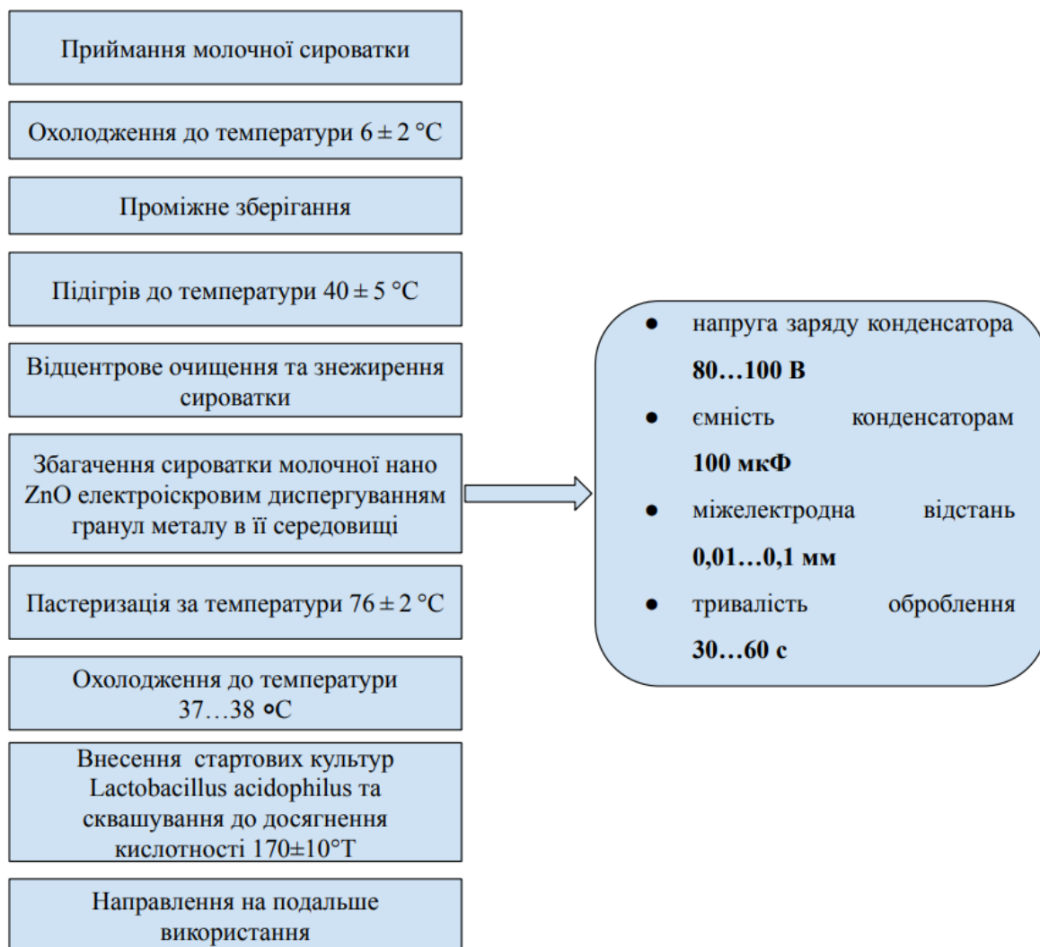
Рисунок 4.8 – Принципова технологічна схема виробництва ферментованої молочної сироватки зі збагаченням наночастинками ZnO
