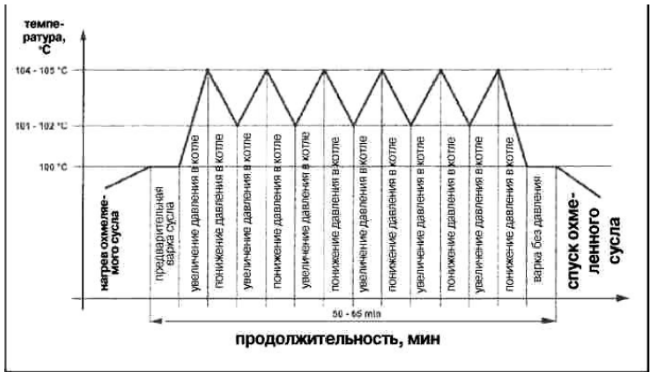
Рис. 2.5 – Спосіб динамічного кип'ятіння сусла за низького надлишкового тиску
