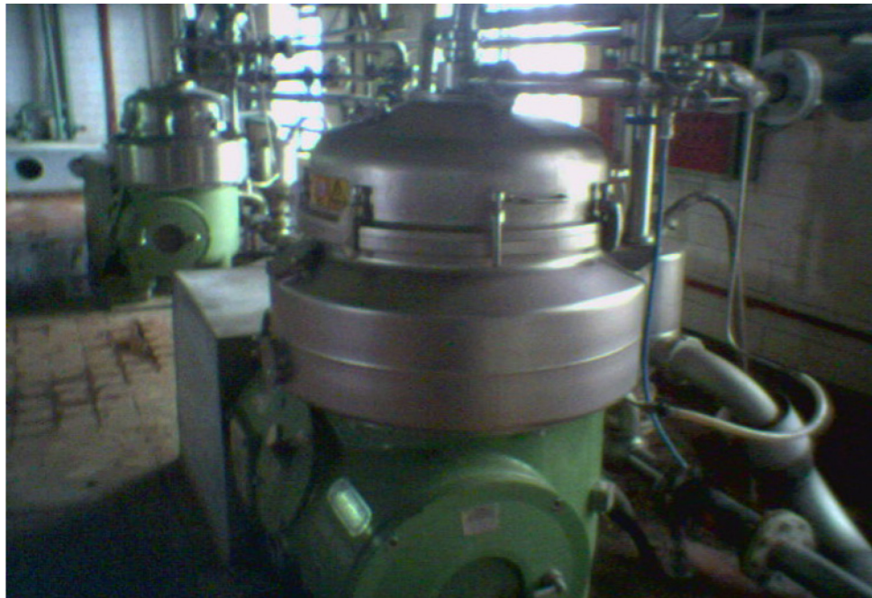
Рис. 2.2 – 2 сепаратора типу HDA 75 06 016, потужність двигуна – 45 кВт (АТЗТ "Одеський дріжджовий завод")
