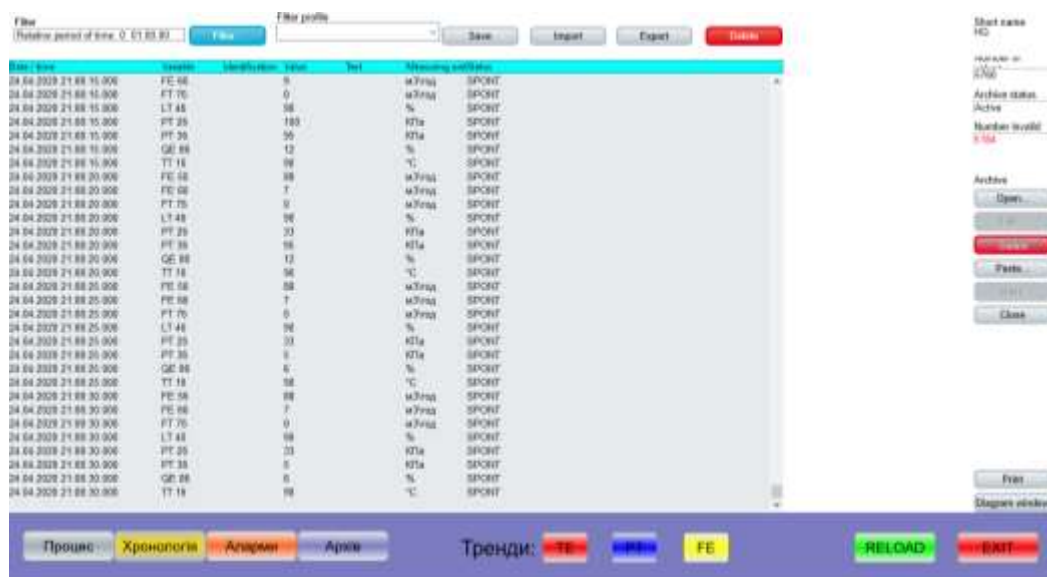
Рис 6.5. Вікно вкладки архів системи автоматизації. Тут можна побачити та переглянути дані про параметри за будь який період
