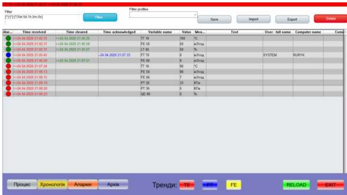
Рис 6.4. Вікно вкладки тривоги системи автоматизації(ALARM). Тут відображаються всі тривоги які виникли, який параметр, коли усунутий чи є дійсним.
