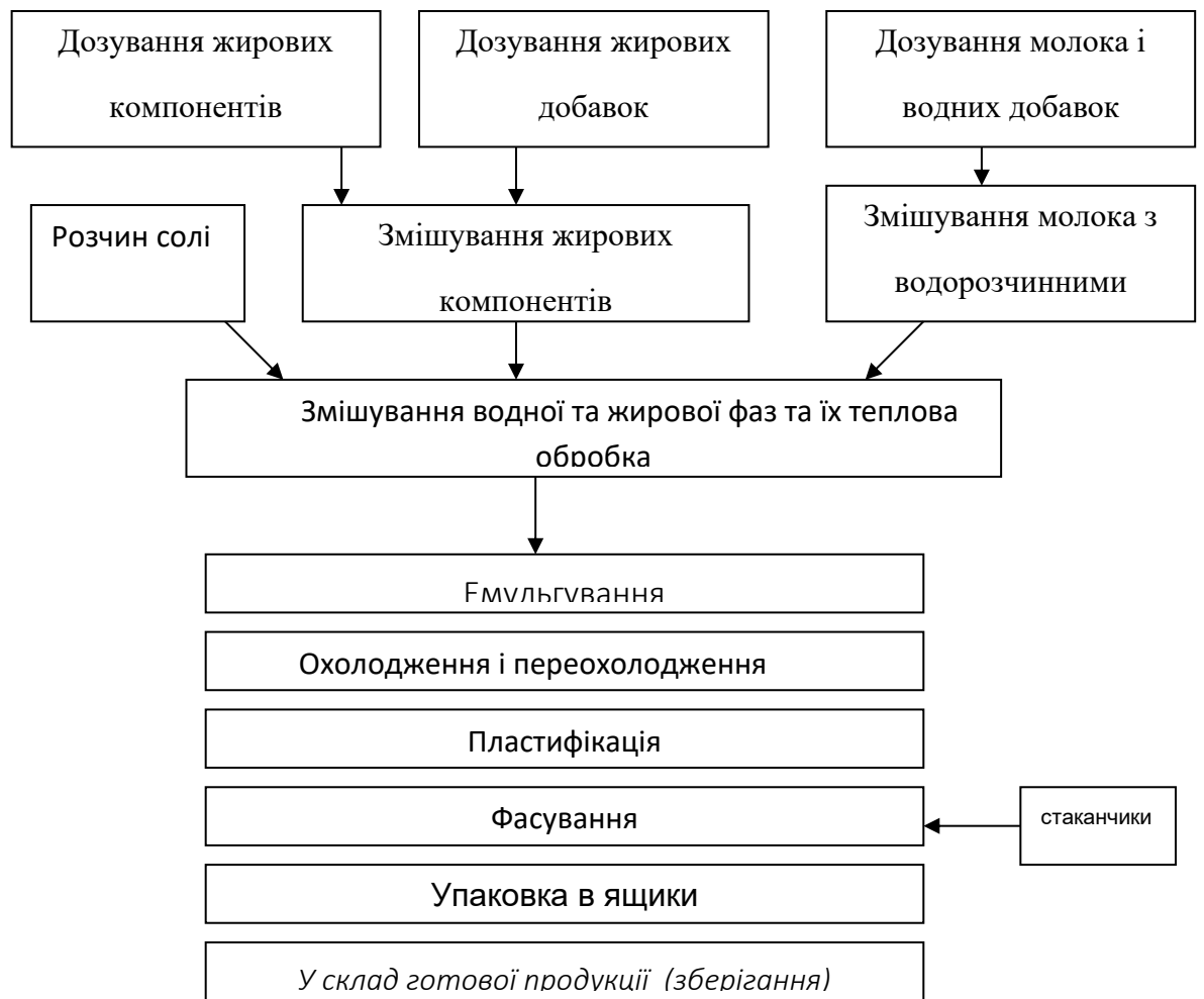
Рис. 2.1. Принципова схема виробництва маргарину
