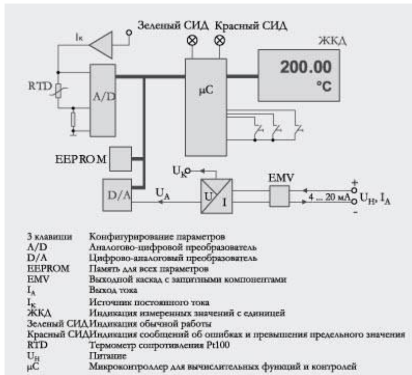
Рисунок 5. Принцип дії перетворювача температури SITRANS TF2
