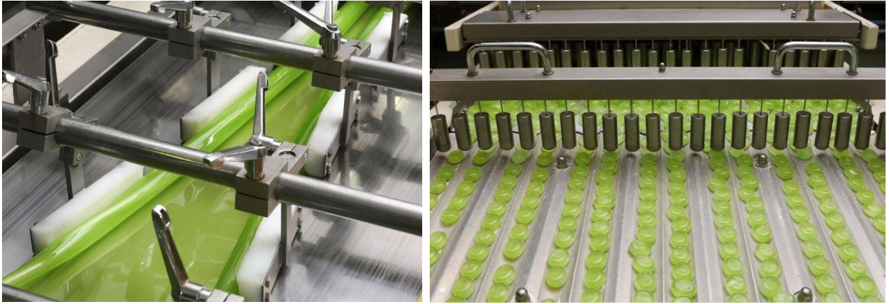
Малюнок 1.4 – Фрагменти автоматизованих ліній виробництва карамелі
