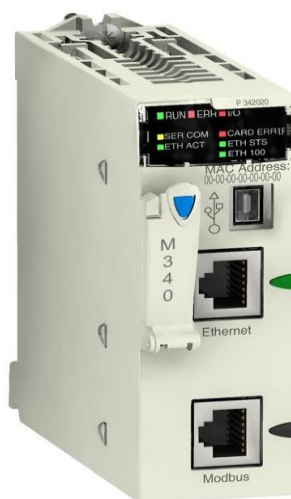
Малюнок 3.29 – Центральний процесорний модуль, BMX P34 2020
