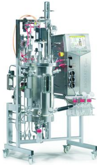
Рис.5.2. Ферментер BIOSTAT Cplus для культивування Bacillus subtilis з метою одержання наночасток золота
