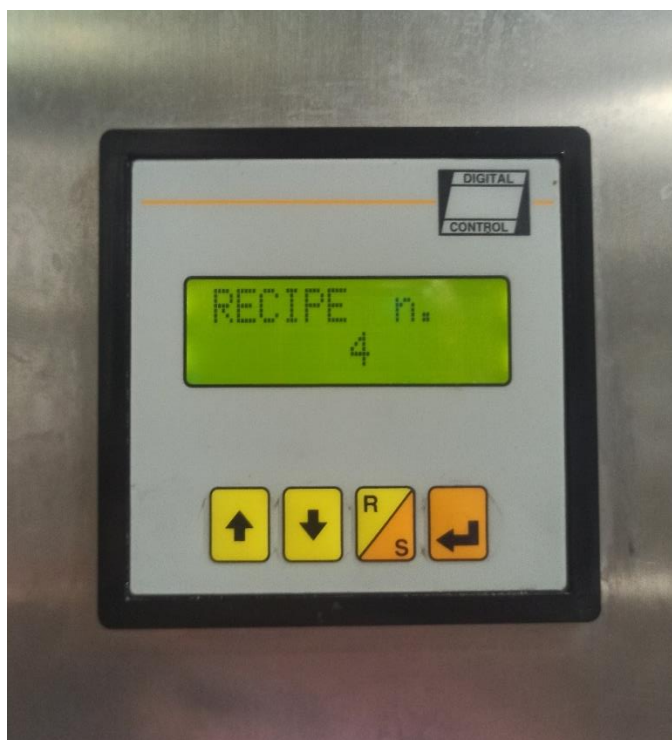
Рисунок 5.6. Операторська панель установки етикетування лінії розливу пива у пляшку
